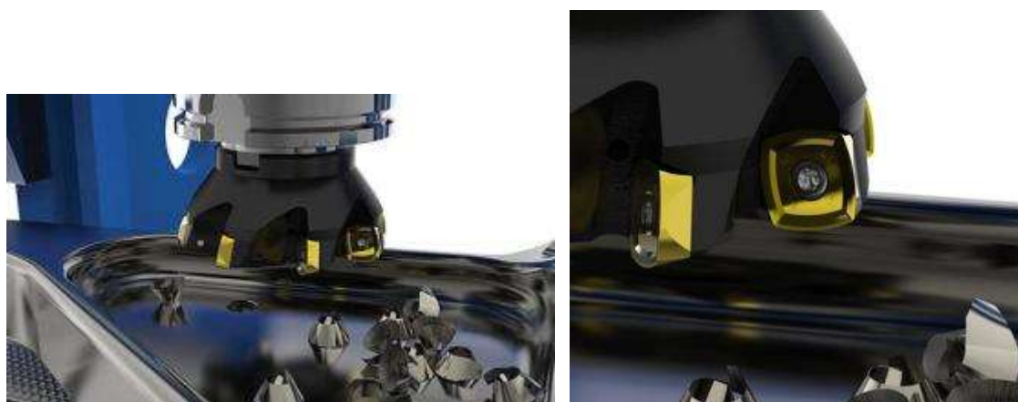
Рис. 3. Высокоскоростная фреза компании Stellram [6]
