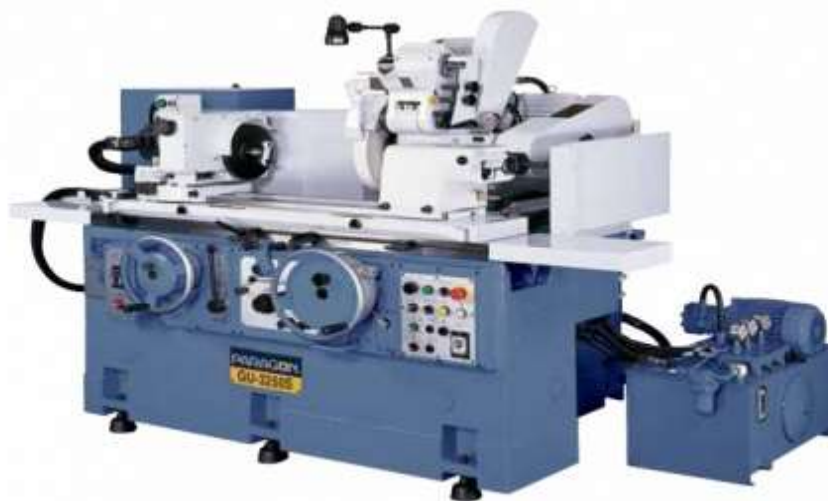
Рис. 1. Круглошлифовальный станок с ЧПУ[1]
