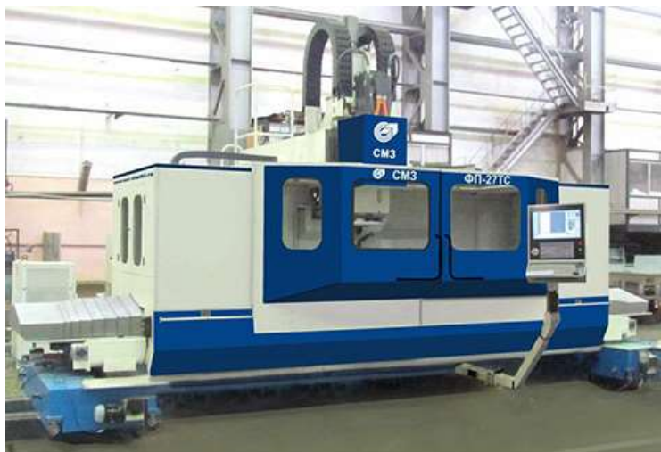
Рис. 1 Станок ФП-27ТС ООО «СМЗ» для обработки титана [2]
