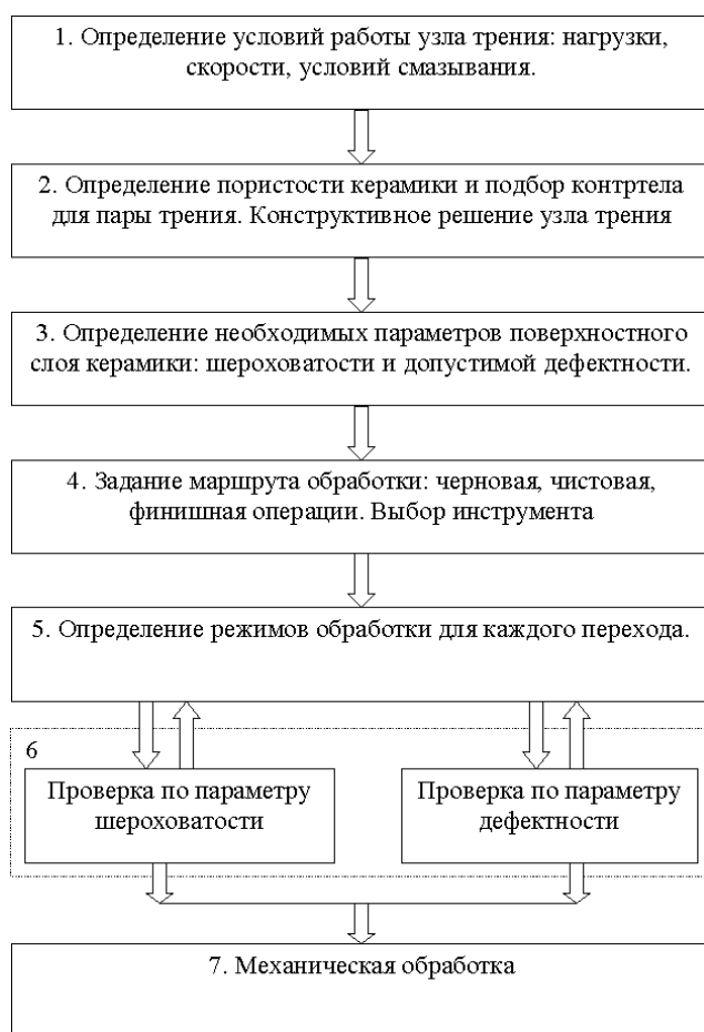
Рис. 1. Структурная схема подбора пары трения на основе оксидной керамики и определения параметров механической обработки
