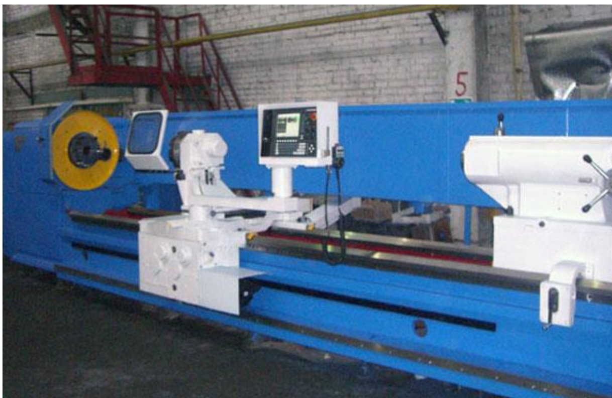
Рис. 2. Вальцетокарный станок с ЧПУ (на базе 1Н65Ф3-3) [2]
