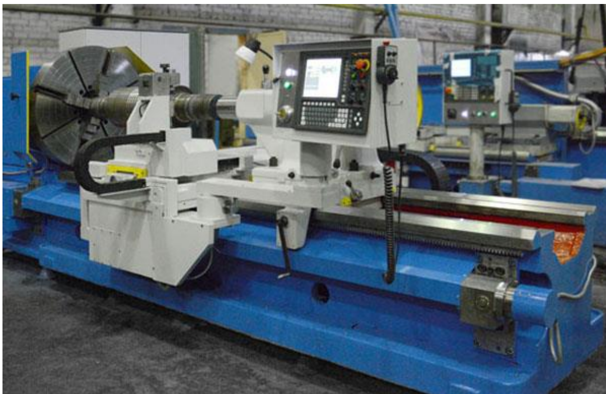
Рис. 3. Вальцефрезерный станок с ЧПУ (на базе 1Н65Ф4-3) [3]
