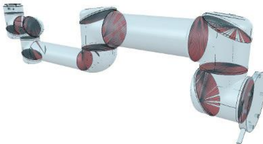
Рис. 6. Упрощенная сетка руки робота при помощи функции «удаление внутренней части сетки»
