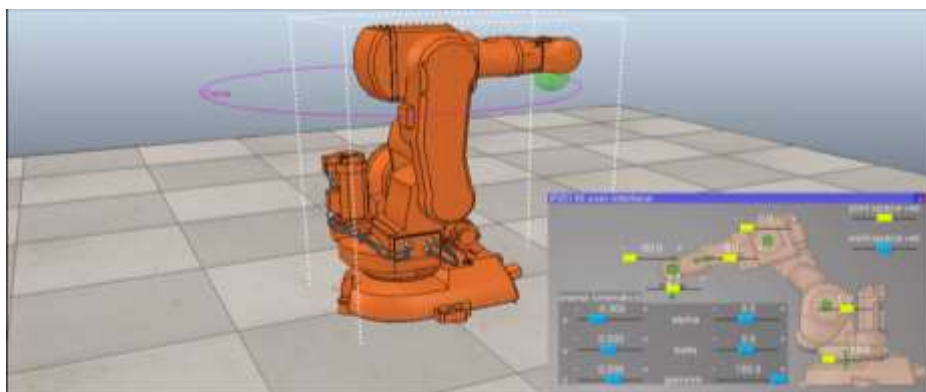
Рис. 1. Траектория движения робота ABB IRB 140 в робосимуляторе V-REP
